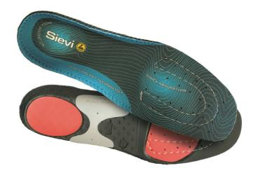
Die Einlegesohle Dual Comfort Plus besteht aus einer komfortablen Oberschicht, einer atmungsaktiven, schnell trocknenden Zwischensohle sowie der stoßdämpfenden EVA-Unterschicht. Die stoßdämpfenden PORON®-Polster reduzieren die Belastung von Ferse und Ballen. Ein weiterer Pluspunkt ist die SieviBalance®-Fußgewölbestütze, welche die Drehsteifigkeit erhöht. Antistatisch und ESD-zugelassen. Handwäsche
